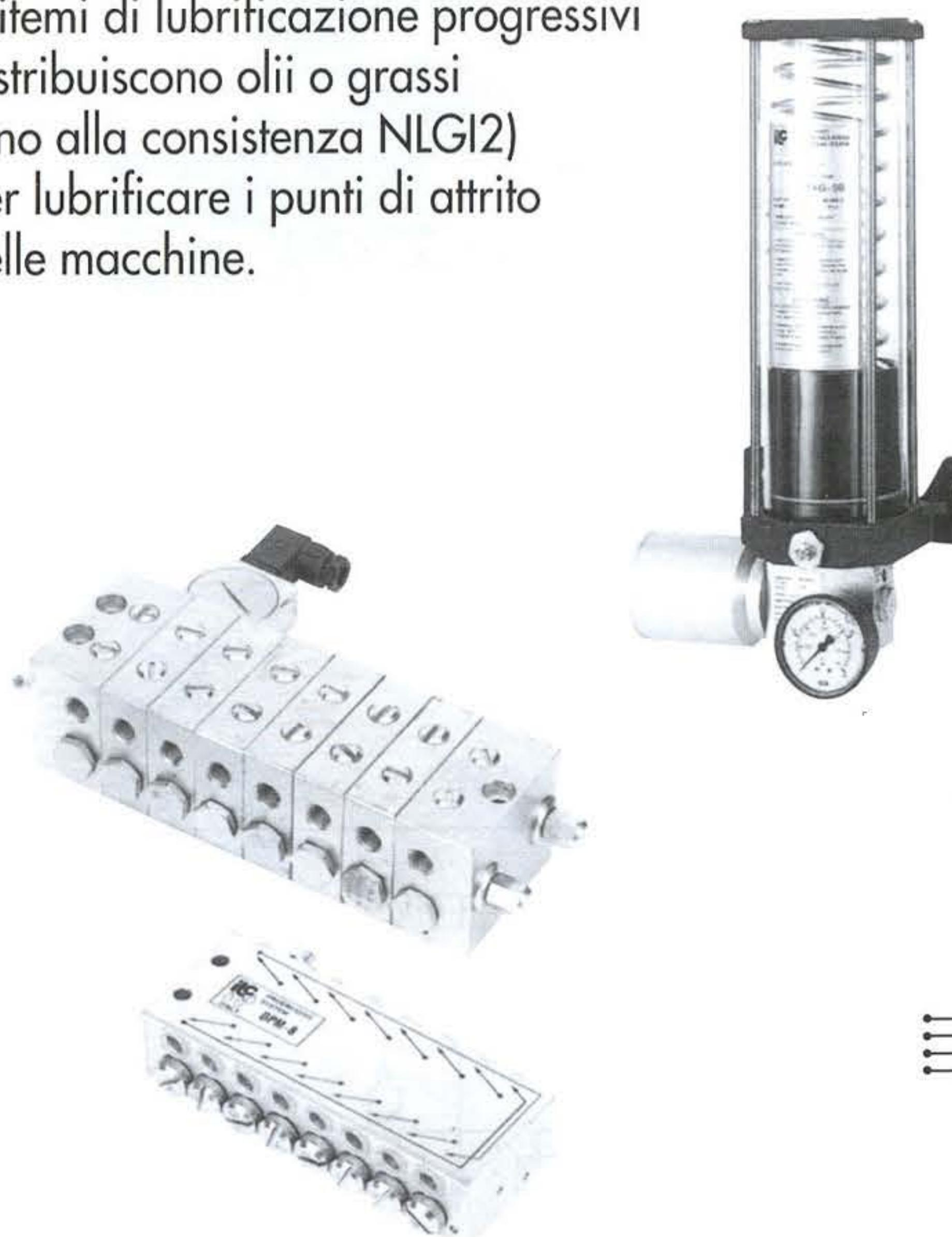
I distributori progressivi possono avere da 3 a 24 uscite e garantiscono una portata da 0.3 a 0.6 cc per ciclo. Il sistema è facilmente controllabile installando un micro di fine ciclo sul distributore principale.
